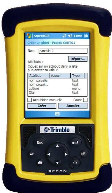
En cochant la case « **Pause** », l'enregistrement de l'objet sélectionné ne démarrera pas immédiatement après avoir cliqué sur OK. Il sera nécessaire de décocher la case « Pause » pour lancer l'enregistrement.
