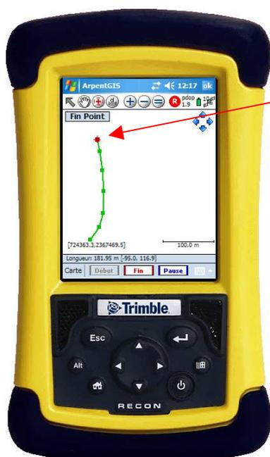
Le point de la ligne dont la position est en cours de moyenne apparaît en rouge. Pour passer au point suivant, il suffit de cliquer sur « Fin Point », de se positionner sur le point suivant et d'enlever la « Pause »...
