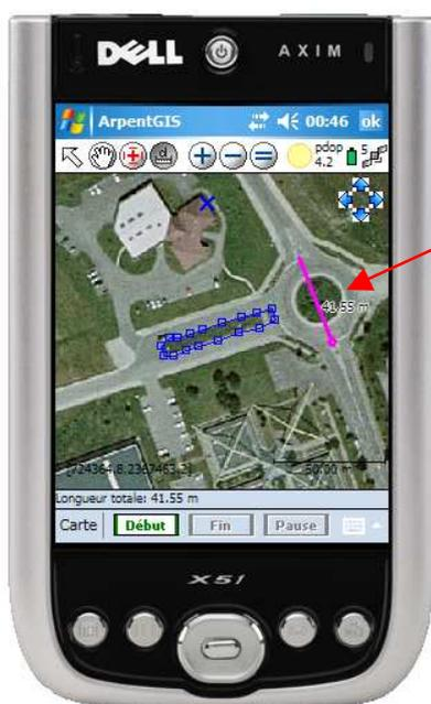
Par exemple pour calculer la distance entre les deux points affichés sur la carte, il suffit de sélectionner l'outil « mesure de distance » depuis la barre d'outil en haut à gauche.
