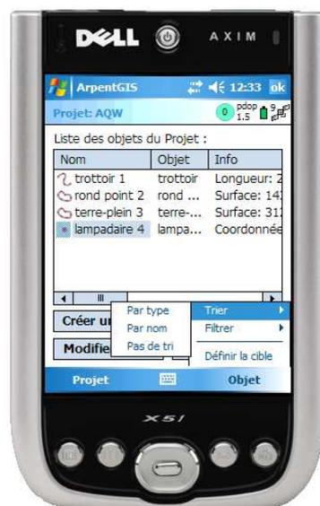
A côté de ce menu déroulant *Projet* se trouve le menu déroulant *Objet*, dans lequel il est possible d'activer des fonctions de *Tri* (par Nom ou par Type), de *Filtre* ou de *Définition d'une cible* pour la fonction *Navigation*
