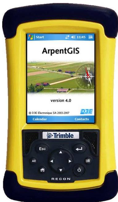
Le logiciel **ArpentGIS** est un logiciel de saisie pour travaux de cartographie, arpentage et renseignement de bases de données géographiques. Il fonctionne sous environnement Windows Mobile 5.
