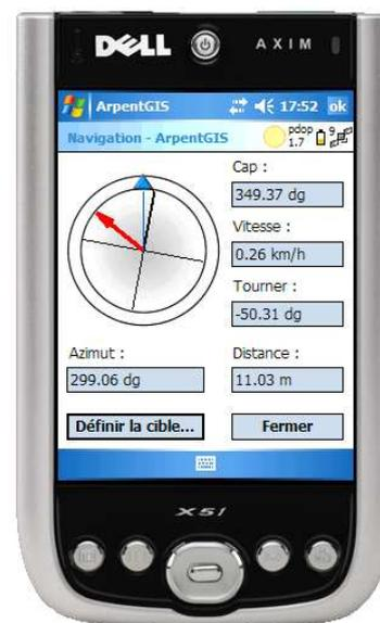
Pour atteindre la Cible, il suffit d'aligner la flèche rouge avec la flèche bleue, et d'amener la distance aux alentours de 0 mètre.
