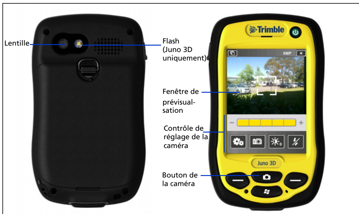
Figure 1.5 Terminal série Juno – contrôles de la caméra
