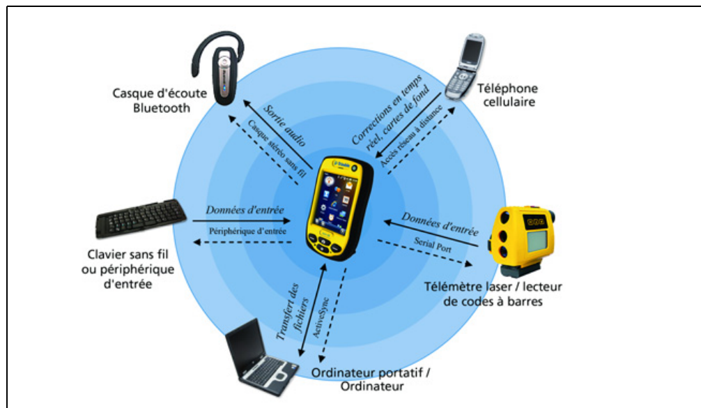
Figure 1.4 Connexions Bluetooth client du terminal série Juno
